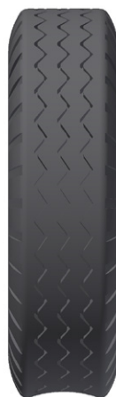
Falta de pressão
